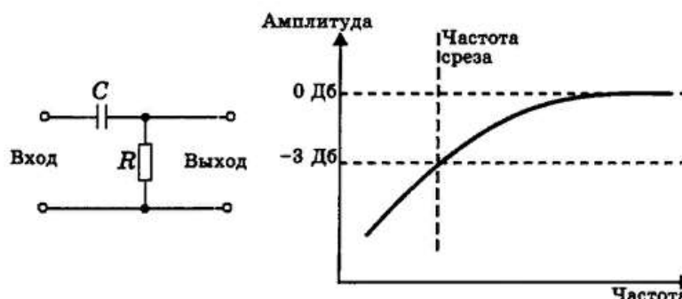
Рис. 1. - Схема амплитудно-частотной характеристики и схема фильтра высоких частот
